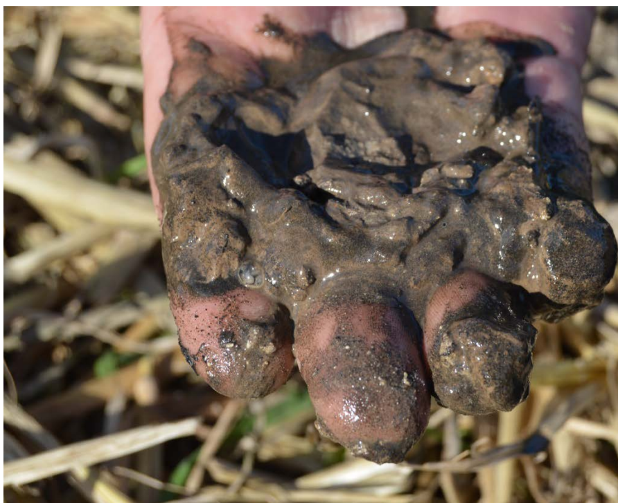
Figur 6. Sediment fra drænrøret. Sedimentet består af meget fine partikler, formentlig primært finsand og silt men muligvis også lidt ler og organisk stof
